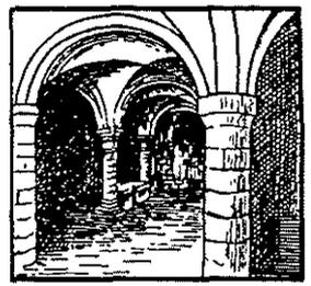
Plan d'une travée voûtée d'arêtes.
