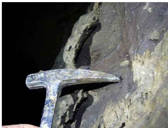
Figure 14. Fantôme de roche. La tête du marteau indique la partie altérée. L'originalité est de se trouver dans une galerie ayant été parcourue par une rivière.
